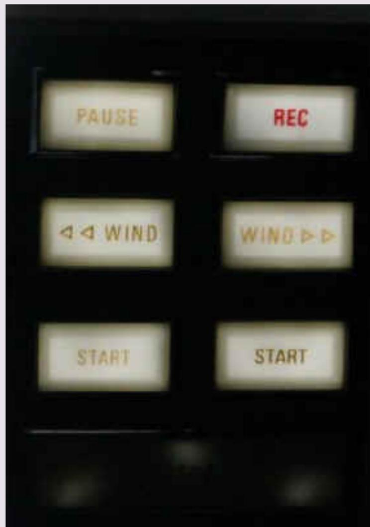
8 Transistoren stecken in diesem schönen Zubehör. Die eingebaute Elektronik dient jedoch ausschliesslich der Steuerung der 6 Lämpchen.
